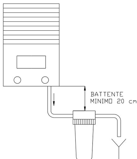
*Il filtro deve avere almeno 20 cm di battente rispetto il punto di scarico della caldaia*
